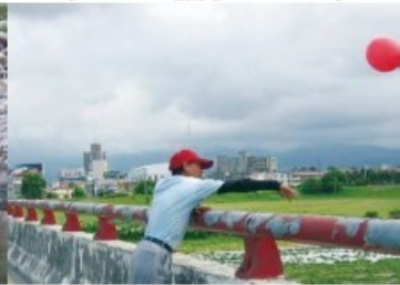
圖 4、拋放浮標量測流速 （資料來源：經濟部水利署）
