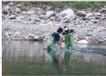
圖 3、以涉測方式進行流量測定 （資料來源：經濟部水利署）
