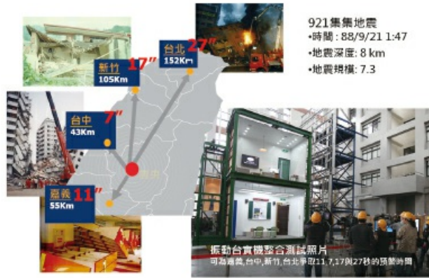
圖二：運用振動台模擬 921 地震，現地型強震即時警報系統可分別為嘉義、臺中、新竹、臺北多爭取 11、7、17 與 27 秒的預警時間
