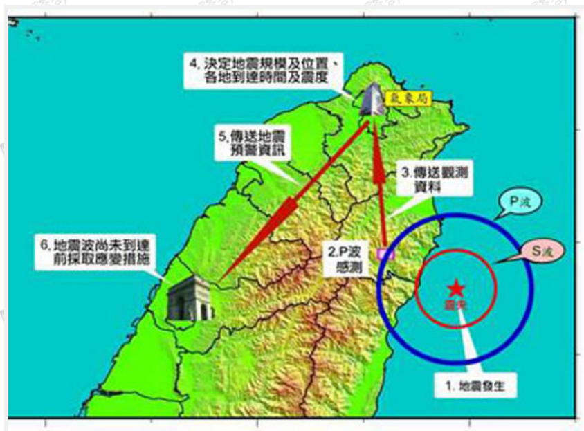
圖2：強震即時警報系統資訊傳送示意圖 （資料來源：國家災害防救科技中心）
