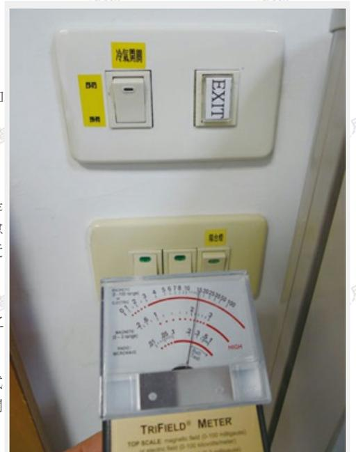
圖一：牆壁電源開關面板所量測之磁場，約2毫高斯
